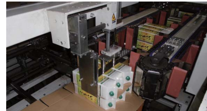
「いいちこパック」をダンボール箱に入れるダンボールケーサー
