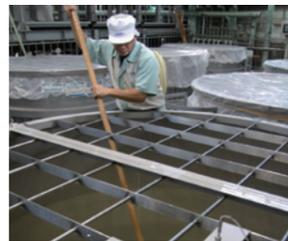
麴と仕込み水、そして酵母をタンクへ仕込み、一次もろみをつくりします。次の二次仕込みでしっかり酵母が働くように、糧(かい)入れと温度の管理が大変重要になります。コポコポと湧くもろみの表情を見極める、職人の腕の見せどころです。
