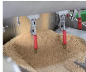
適量な水分を吸わせた大麦を、蒸し器で蒸し上げます。硬すぎず、柔らかすぎず、絶妙なバランスが求められるため、慎重に作業します。このときの蒸し加減で、その後の麴ともろみの出来が大きく変わってきます。
