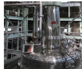
減圧蒸留法により低温でもろみを蒸留することで、もろみの華やかな香気を引き出します。求める酒質に合わせて、温度や時間を調整していきます。蔵のノウハウが問われる重要な工程です。
